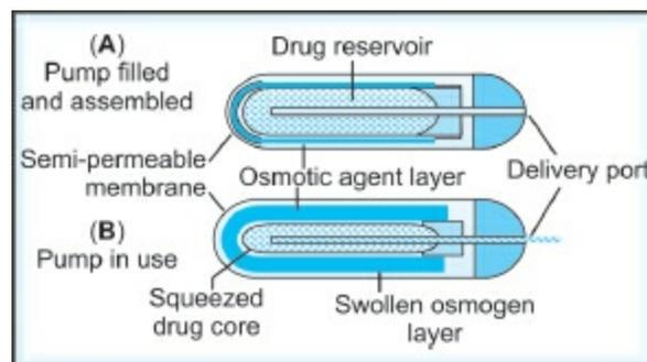
**Fig. 24.4:** Alza mini-osmotic pump (Alzet<sup>®</sup>)
