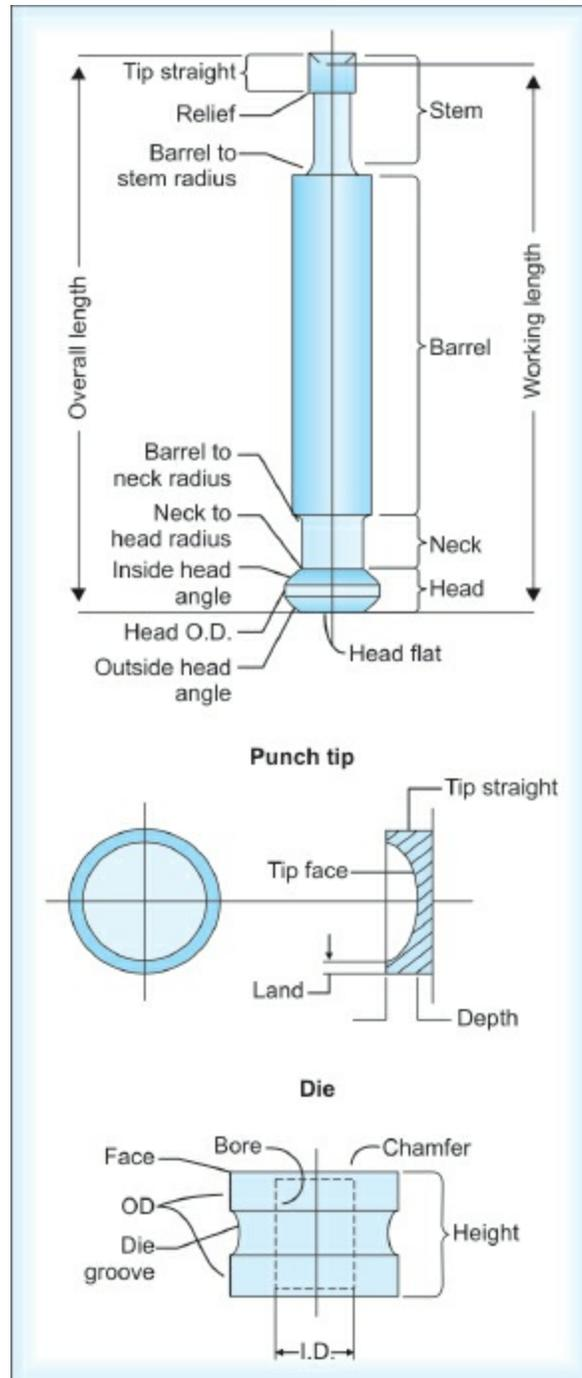
**Fig. 13.9:** Tablet press tooling nomenclature
